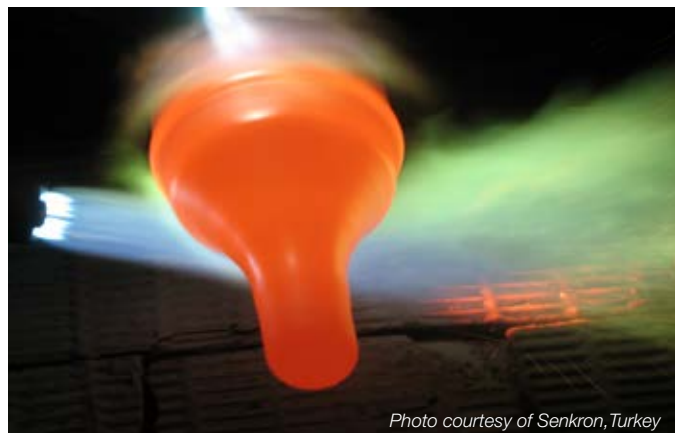
図25 プランジャーへのフュージング完了
