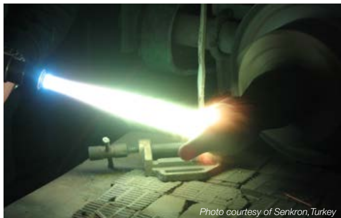
図24 フレームをプランジャー部へ移動
