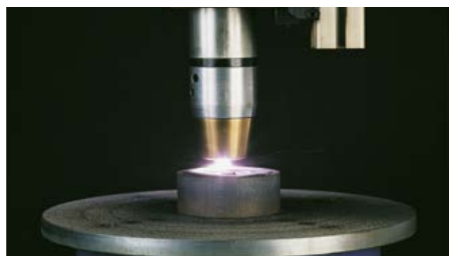
図31 PTAによる皮膜の生成
