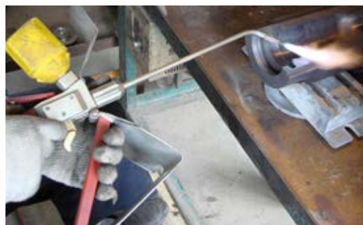
図16 金型端部への粉末溶接
